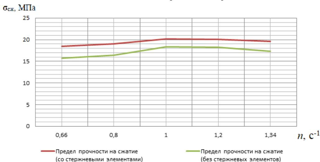
Рис. 6. Изменение предела прочности на сжатие половинок образцов-призм из смесей, приготовленных в смесителе со стержневыми элементами и без стержневых элементов
